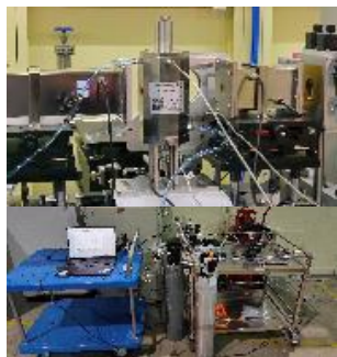
基于XAS的原位失活机制研究组件和数据拾取、分析方法 In-situ XAS data collection, processing, and interpretation
